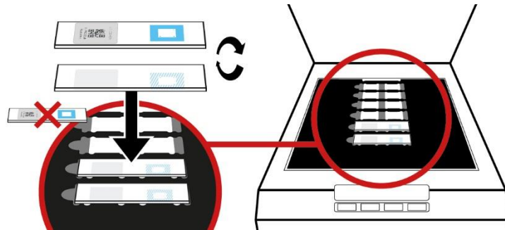
Εικόνα 4: φόρτωση των VisionArray Chip στη βάση στήριξης πλακιδίων του σαρωτή V600 Photo
